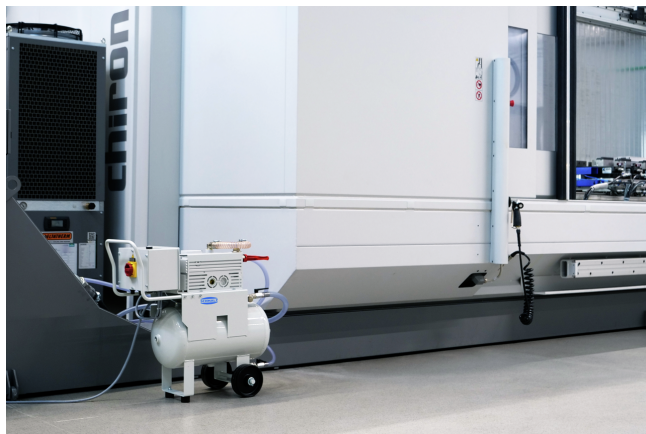
Unité de vide VAGG pour la génération du vide sur un centre d'usinage CNC
